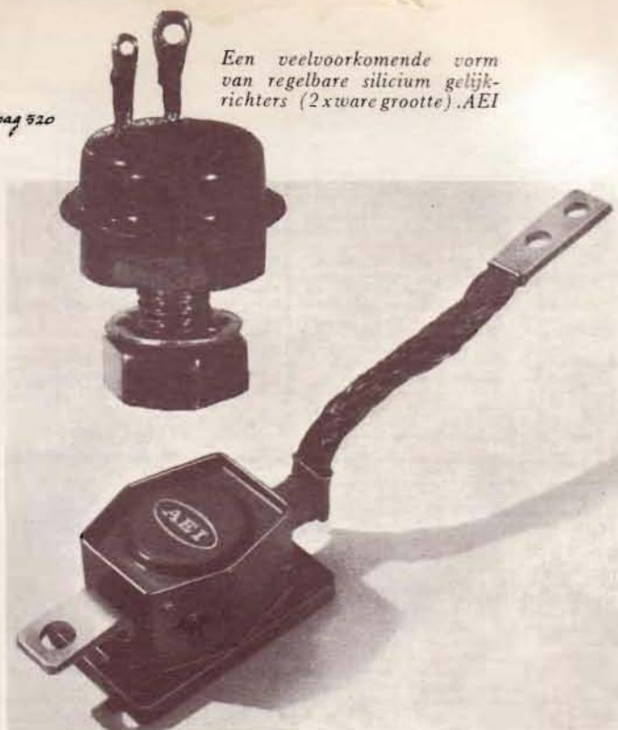
Experimentele 100 ampere RSG. De voet van deze unit is ongeveer 40 x 65 mm.
